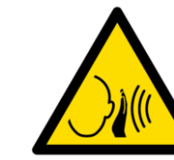
Peligro de ruido
